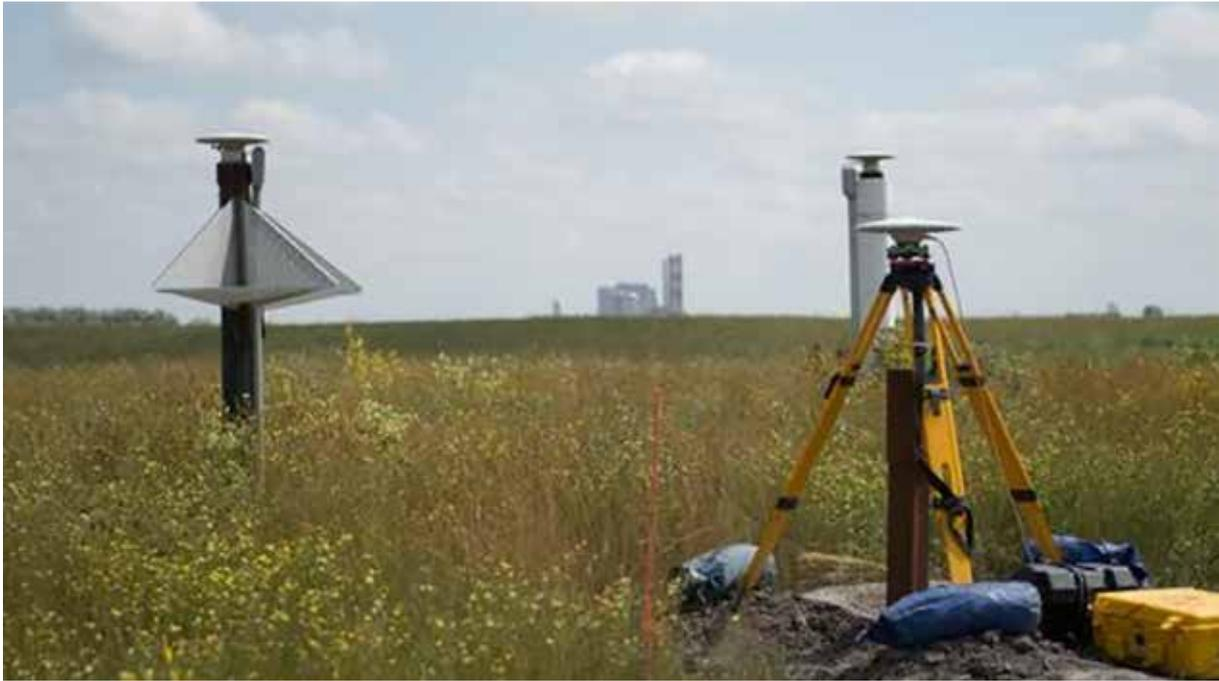
说明: Aquistore CO<sub>2</sub> 封存点的地面监测设备。边界坝 3 项目碳捕集设施（远景）通过管道将 CO<sub>2</sub> 注入地下深处（3.4 公里）并永久封存（资料来源：石油技术研究中心（PTRC））。
